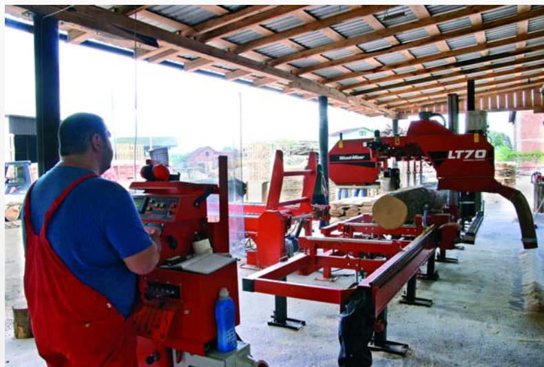
Банцигът LT 70R с дистанционно управление, напречен транспортър и сортиращ транспортър, работещ в хърватското предприятие
