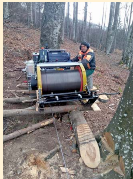
Горната станция на дългометражната въжена линия, където е монтиран моторът
