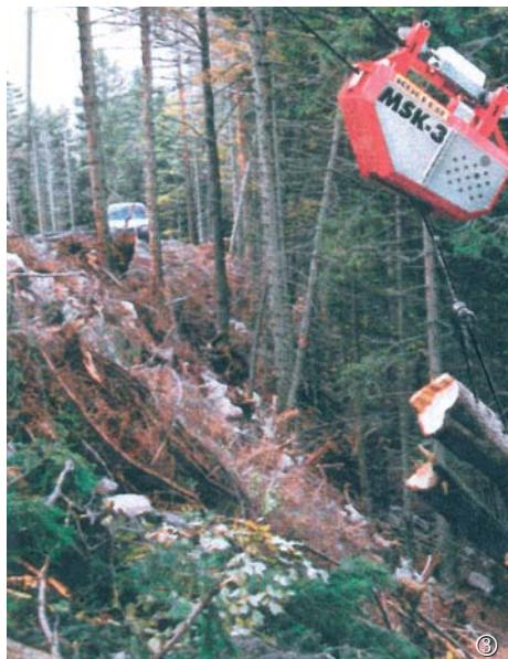
Висенова моторна автоматична вагонетка тип MSK-3 с радиоуправление
