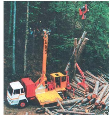
Мобилен мачтова въжена линия K-500, съоръжена с хидравличен кран и работна кабина
