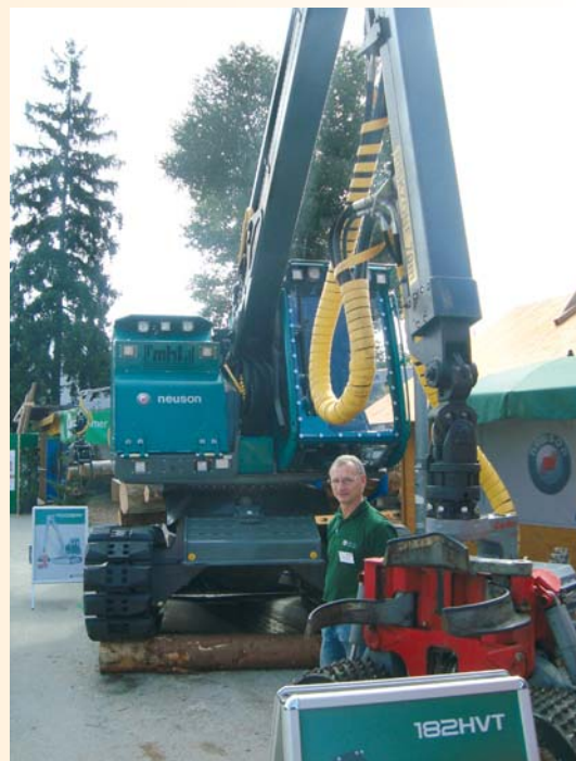
Верижният харвестер Neuson-Ecotec с „пластмасови“ вериги е подходящ за работа както във влажни, така и в планински и полупланински терени
