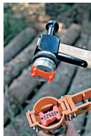
Устройството за поставяне на пластините се състои от пълнител, в който се зареждат пластините с пореден номер, и чука, с който се поставят на дървесината
