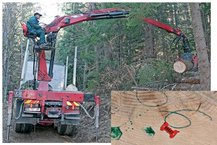
Товарене на маркираната дървесина от временен склад. На този етап са поставени контролната горска марка и пластмасовата пластина
