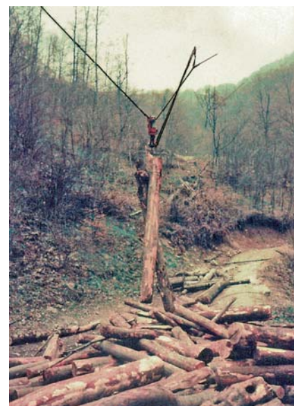
Фиг. 6. Извоз на дървени материали с въжена линия „Пирин“, съоръжена с автоматична товарна вагонетка ВА-10Х
