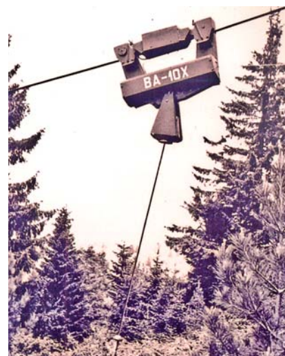
Фиг. 5. Общ вид на автоматична товарна вагонетка ВА-10Х
