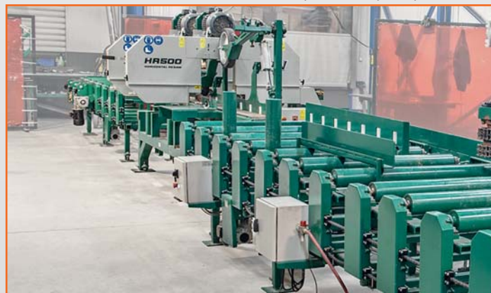
Многоглавият банциг HR 500 може да притежава до 6 режещи глави
