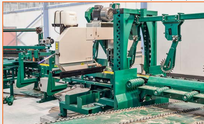
Хоризонталният банциг SHS обработва двустранната призма в тристранна
