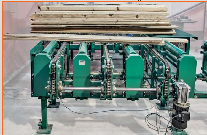
Линията е предназначена за производството на всякакъв фасониран материал с правоъгълно сечение, но основно се използва за производството на палетни дъски
