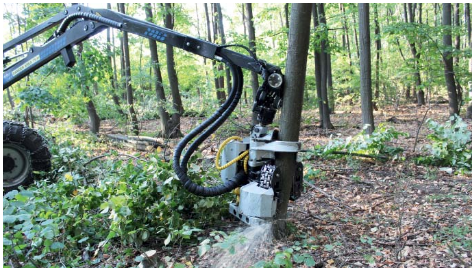
Харвестър „Viteck 404SE“ при повалине на дърво
