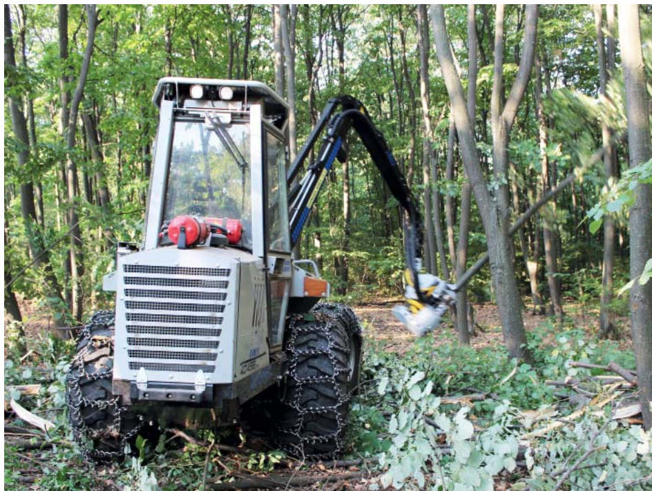
Харвестър „Viteck 404SE“ обработва ствол при прореждане на липова култура
