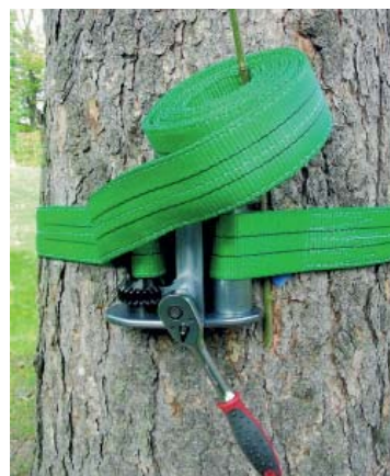
Преса (колан) за стягане на наклонените стъбла за предотвратяване на сцепване
