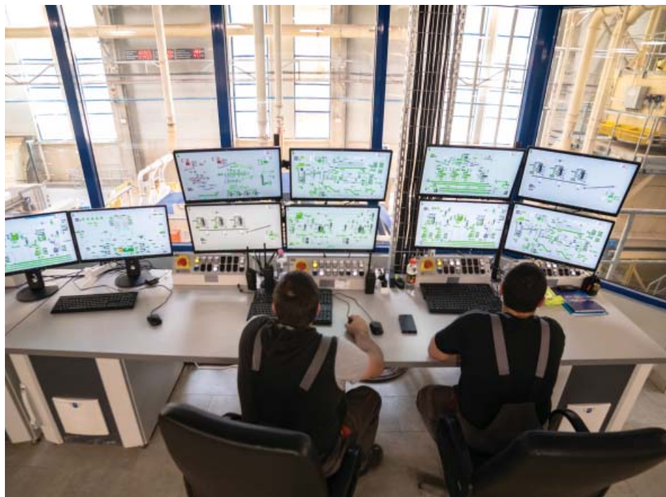
Интелигентна онлайн система за контрол и управление на производствения процес и постоянно поддържане на системата по зададените параметри (зелена зона)
